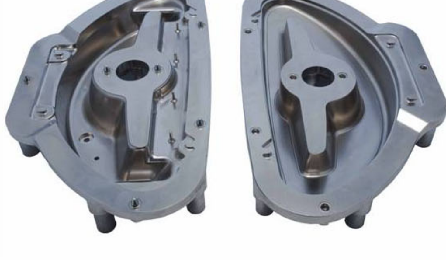
Stampo con trattamento never ending. (Per gentile concessione Linpac)
