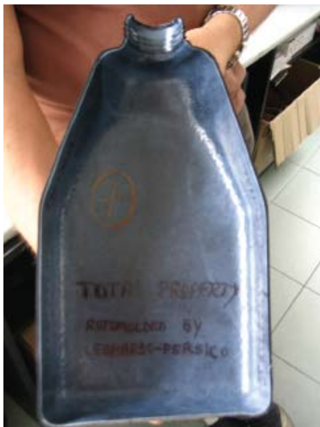
Figure 4: : Internal Surface of 8 liter (2.1gall) Part Produced on Leonardo Machine. Superficie interna di un pezzo di 8 litri (2,1 galloni) prodotto con una macchina Leonardo.
