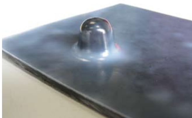
Figure 6: Complete Coverage of Inserts by Inner Layer Lo strato interno ricopre completamente gli inserti
