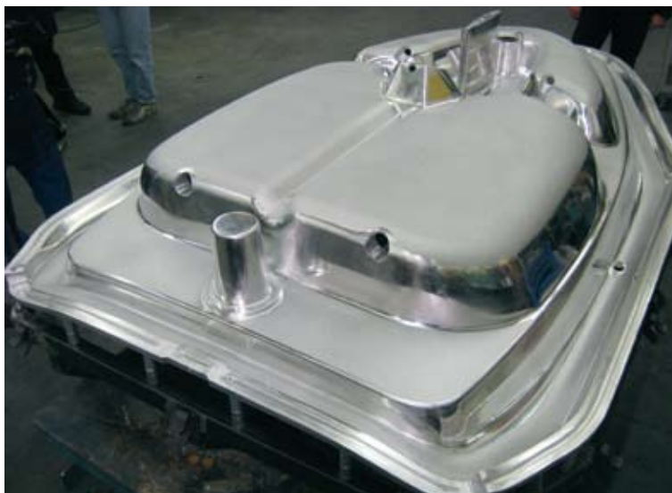
CNC Machined Mold for a Sailing Boat 102x39x23 inches (2600x1000x600mm) Stampi fresati a CNC per lo scafo di un'imbarcazione 2600x1000x600mm
