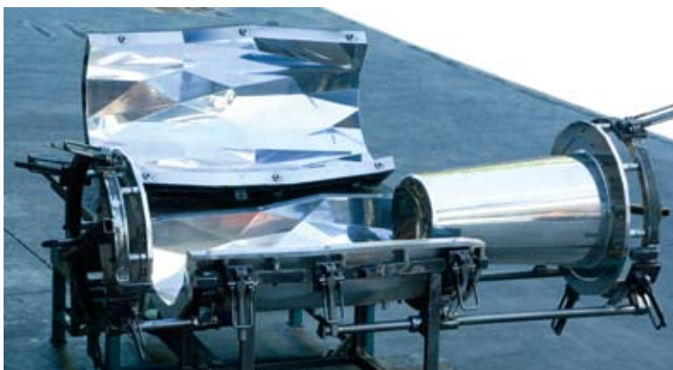
CNC Machined Mould in 4 Pieces (a total of 35 aluminium parts joined together) for Offshore Buoyancy Module 95x50x36 inches (2421x1270x916mm) Courtesy of Remcon Plastics Inc. Stampo fresato a CNC in 4 parti (per un totale di 35 parti di alluminio assemblate) per modulo galleggiante di offshore (2421x1270x916mm) Per gentile concessione di Remcon Plastics Inc.
