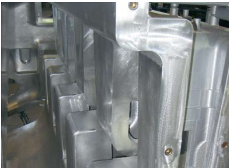
CNC Machined Mould in 4 Pieces (a total of 35 aluminium parts joined together) for Offshore Buoyancy Module 95x50x36 inches (2421x1270x916mm) Courtesy of Remcon Plastics Inc. Stampo fresato a CNC in 4 parti (per un totale di 35 parti di alluminio assemblate) per modulo galleggiante di offshore (2421x1270x916mm) Per gentile concessione di Remcon Plastics Inc.
